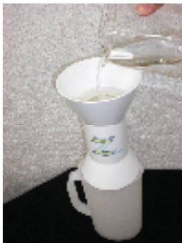
非常用コンパクト純水器「Z」通水試験状況
